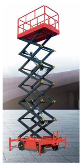
移动式剪叉升降平台是用途广泛的高空专业设备。它的剪叉式机械结构,使升降平台起升后有较高的稳定性,宽大的作业平台和较高的承载能力,使高空作业范围更大,并适合多人同时作业。它使高空作业效率更高,安全更有保障。
